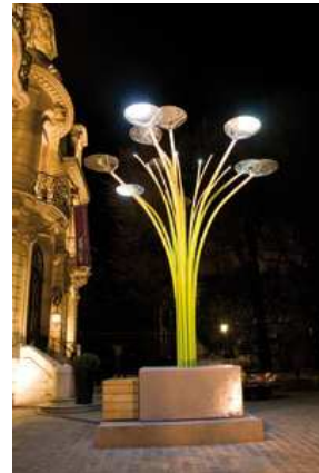
Luminaire urbain en forme d'arbre, composé de vingt bras cintrés en acier laqué vert, la moitié intégrant en tête une led de 1 watt de
